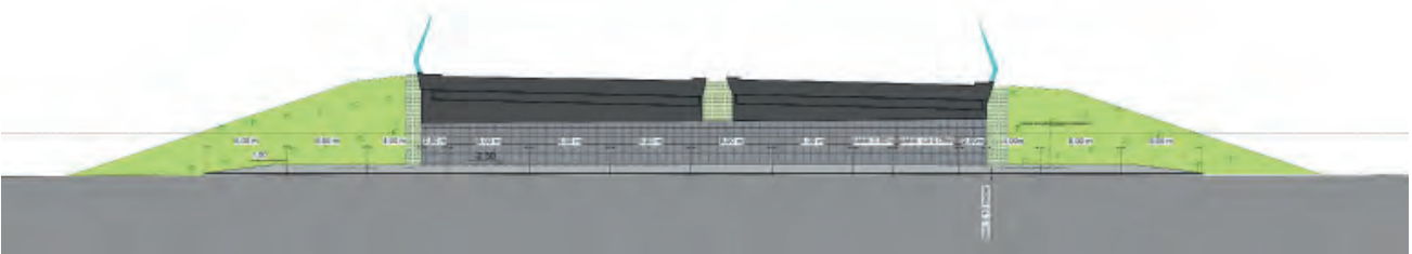
Halve stepbarrier als afwerking van betonnen damplanken
