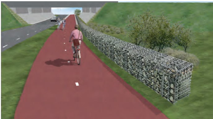
Uitwerking schanskorven, breedte 0,60 meter
